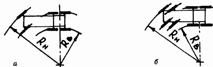
Рис. 4.2 Способы поворота многоосных автомобилей: а — трехосного и б — четырехосного
