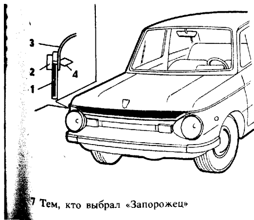
Рис. 32. Защита щели багажника: 1 — резиновая полоса, 2 — молдинг, 3 — стенка крышки, 4 — пистон
